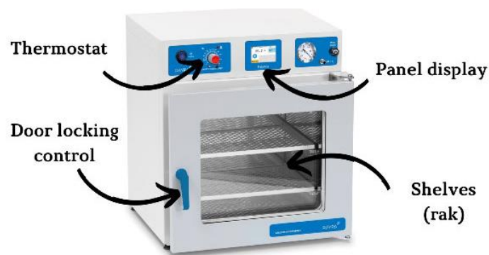
Gambar 5. Bagian-bagian oven pada laboratorium kultur jaringan tanaman (Sumber: andarupm.co.id)
